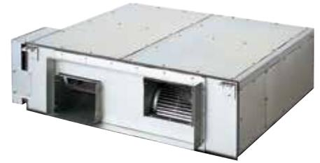
Conduit haute pression et fonction de conduit d'admission de 100 % d'air frais. La gamme d'unités gainables E2 offre une plus grande flexibilité de conception pour les configurations de gaines étendues du fait de l'augmentation des pressions statiques externes et de la réduction de la consommation d'énergie.
