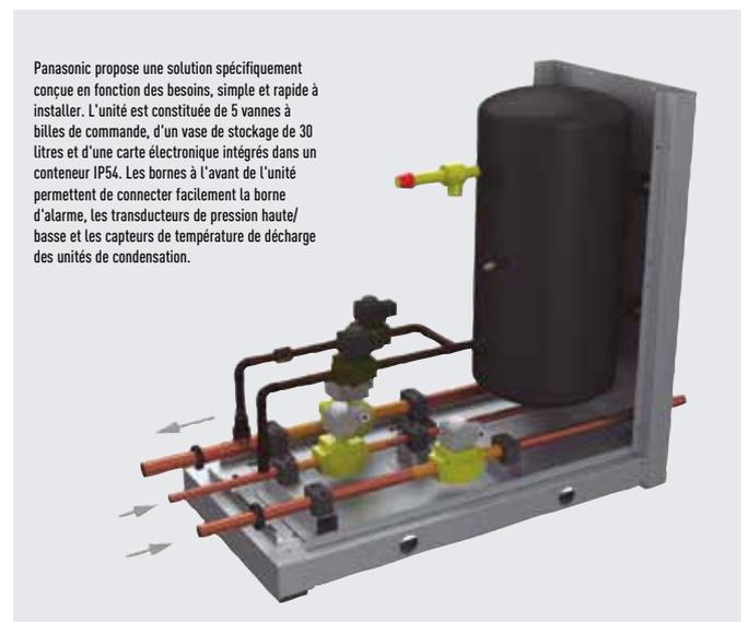
Panasonic propose une solution spécifiquement conçue en fonction des besoins, simple et rapide à installer. L'unité est constituée de 5 vannes à billes de commande, d'un vase de stockage de 30 litres et d'une carte électronique intégrés dans un conteneur IP54. Les bornes à l'avant de l'unité permettent de connecter facilement la borne d'alarme, les transducteurs de pression haute/basse et les capteurs de température de décharge des unités de condensation.
